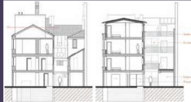
Coupes transversales, existant et projet, illustrant l'escalier extérieur et les coursives créées sur les bâtiments de la cour (© Fendler Seemuller architectes).
